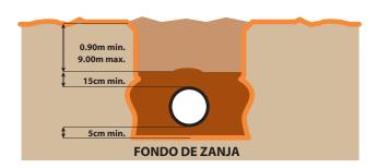
El material de excavación debe ser depositado a cierta distancia del borde de la zanja, dependiendo esta de la profundidad de la misma, para evitar una sobrecarga del talud que puede originar derrumbes de las paredes laterales, lo que podría ocasionar accidentes personales y/o destrucción de la tubería por impacto.
