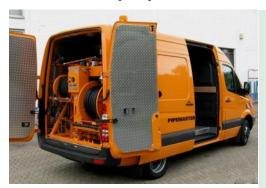
Por tamaño o tipo de trabajo se utilizan vehículos de impulsión, sólo para limpieza y arrastre de lodos, o de succión, sólo para la retirada de lodos.
